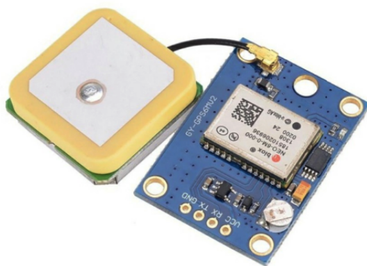
Figura 3.13: Módulo GPS NEO-6M V2 [Ful22].
