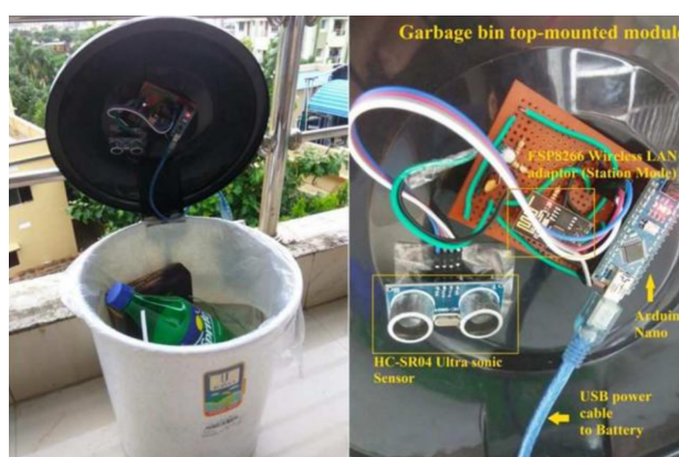
Figura 2.5: Caixote do lixo inteligente e seus componentes [MR20].
