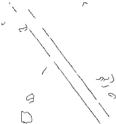
(b) Mapa de pontos de contorno resultantes do processo de detecção com emagrecimento por meio de operador morfológico.
