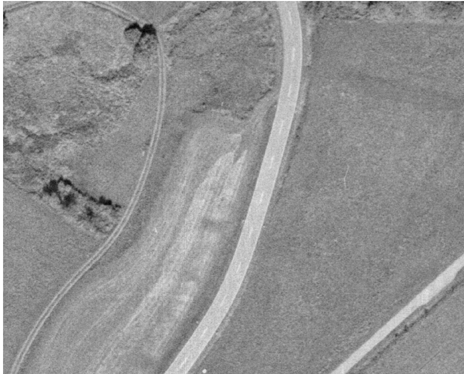
Figura 4.12.: A figura mostra, claramente, o desenvolvimento de uma estrada. É uma imagem aérea digital de níveis de cinzento com oito bits de resolução de intensidade e 870 \times 1170 pixel , que apresenta uma resolução espacial de 0,25 metros.
