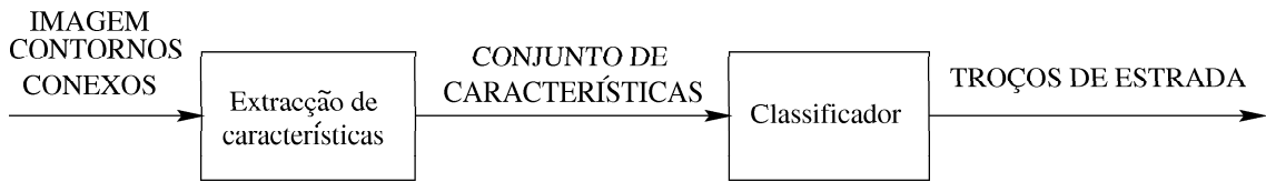
Figura 4.18.: Diagrama de blocos que ilustra a estrutura do reconhecedor de padrões utilizado nesta dissertação.
