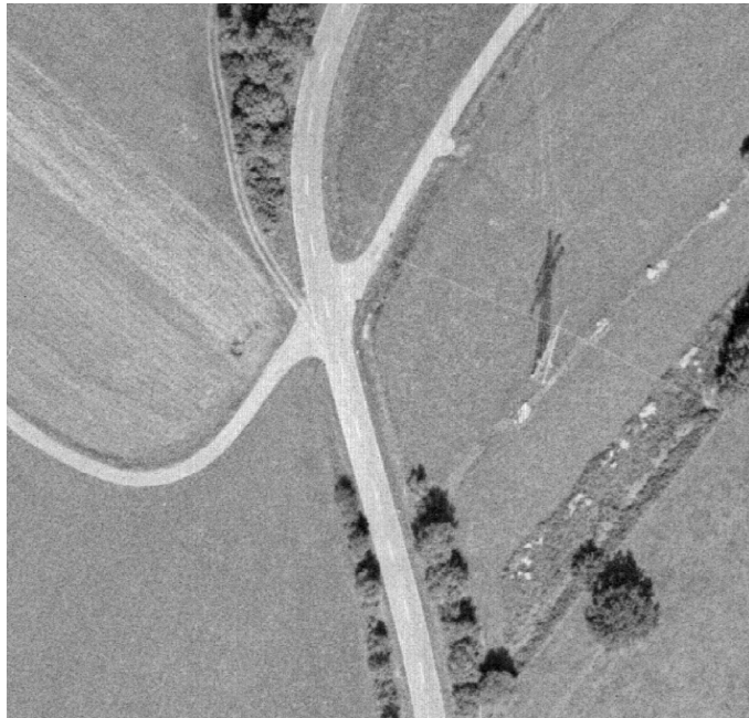
Figura 4.2.: Os cruzamentos introduzem situações que representam alterações das características geométricas de um troço de uma estrada. O troço de estrada que se desenvolve da parte inferior para a parte superior da imagem apresenta uma largura constante, excepto na zona de cruzamento. As linhas definidoras das margens do troço de estrada em referência apresentam-se paralelas, excepto na zona de cruzamento. Adicionalmente, as margens do troço de estrada referido, durante a transposição do cruzamento, passam a margens do troço de estrada que lhe é aproximadamente perpendicular, aumentando assim a complexidade da respectiva classificação. A imagem encontra-se ortorectificada e é um extracto da imagem ilustrada na Figura 4.7.
