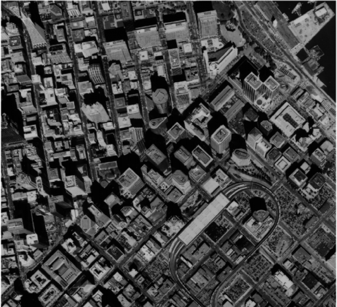
Figura 4.8.: A imagem da figura ilustra uma zona urbana. Nela pode observar-se a elevada complexidade que a mesma comporta, pois facilmente pequenos troços de estradas se confundem com, por exemplo, as coberturas dos edifícios. A extracção automática torna-se, deste modo, mais complexa, obrigando à introdução no modelo de um maior conhecimento dos objectos contidos na imagem. É uma imagem com 256 níveis de cinzento e encontra-se ortorectificada.
