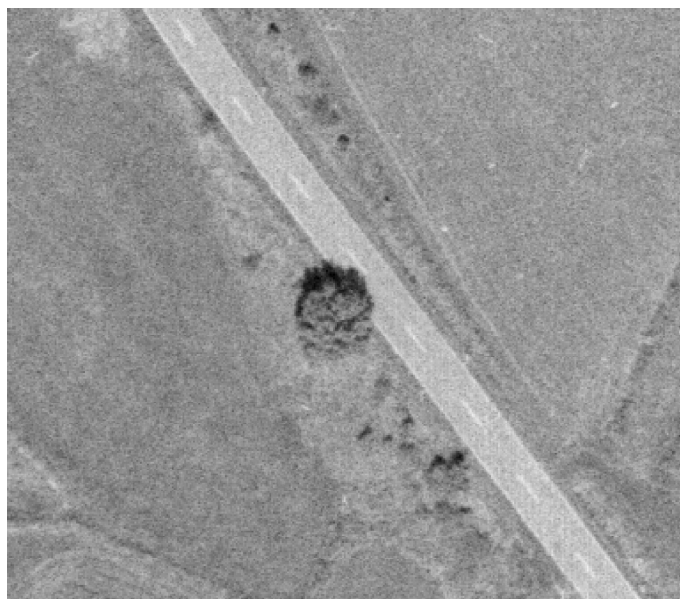
Figura 4.3.: As zonas de sombra nas imagens aéreas não possibilitam, em geral, a aquisição de dados sobre os objectos nela inseridos. Na imagem da figura, pode observar-se a existência de uma sombra provocada por uma árvore (zona central da imagem). A sombra cobre parcialmente o troço de estrada. Recorrendo, por exemplo, à detecção de contornos — uma técnica de processamento digital de imagem — para a extracção das suas margens, obtém-se duas linhas que na zona de sombra não são paralelas. A imagem encontra-se ortorectificada e é um extracto da imagem ilustrada na Figura 4.7.
