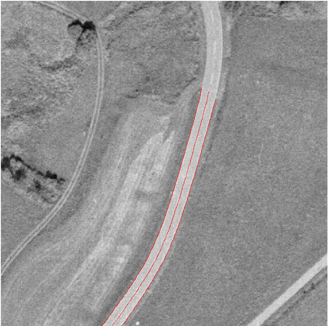
Figura 5.8.: A imagem representada pela figura, exibe a sobreposição de uma parte dos contornos, previamente emagrecidos, das margens da estrada à imagem original. Exibe, também, a sobreposição sobre a imagem original dos pontos que foram determinados como eixo da via.
