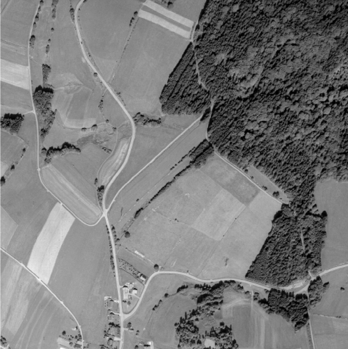
Figura 4.7.: A imagem da figura ilustra uma zona rural. Nela pode observar-se a baixa complexidade que a mesma comporta, identificando-se com alguma facilidade, através de observação visual, os elementos nela contidos, como por exemplo, as estradas. É uma imagem com 256 níveis de cinzento encontra-se ortorectificada.
