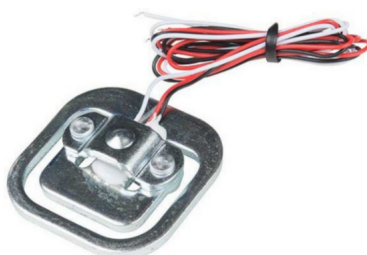
Figura 4.8: Célula de carga de 50Kg com 1/2 ponte de Wheatstone [86].
