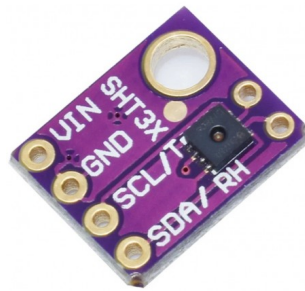
Figura 4.4: Módulo com sensor de temperatura e humidade ambiente SHT30 [81].
